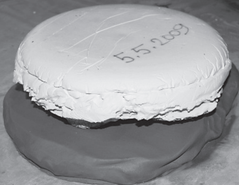
Obr. 2 – Vyztužený sádrový odlitek připravený k obtisknutí do hlíny.
